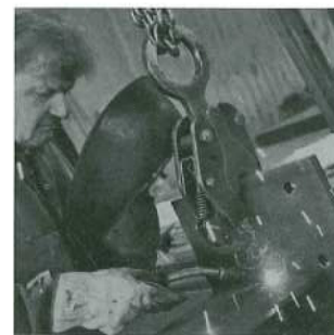
Bild 1. Altmodischer Zusammenbau von Stahlträgern
